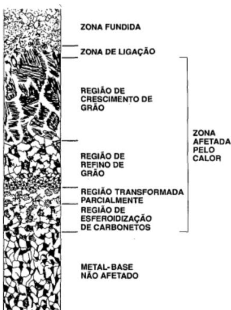
Figura 11 - Microestruturas típicas da zona termicamente afetada de aço carbono [33]
